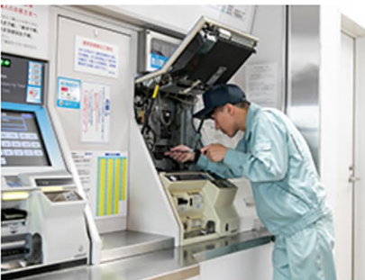
自動券売機の定期検査
